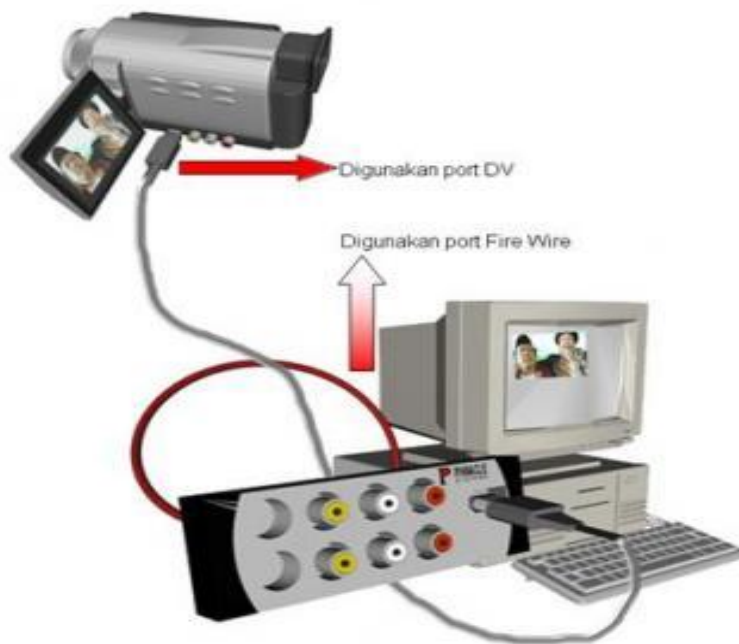
Gb.19 Kamera video yang dihubungkan ke komputer dengan kabel Firewire
