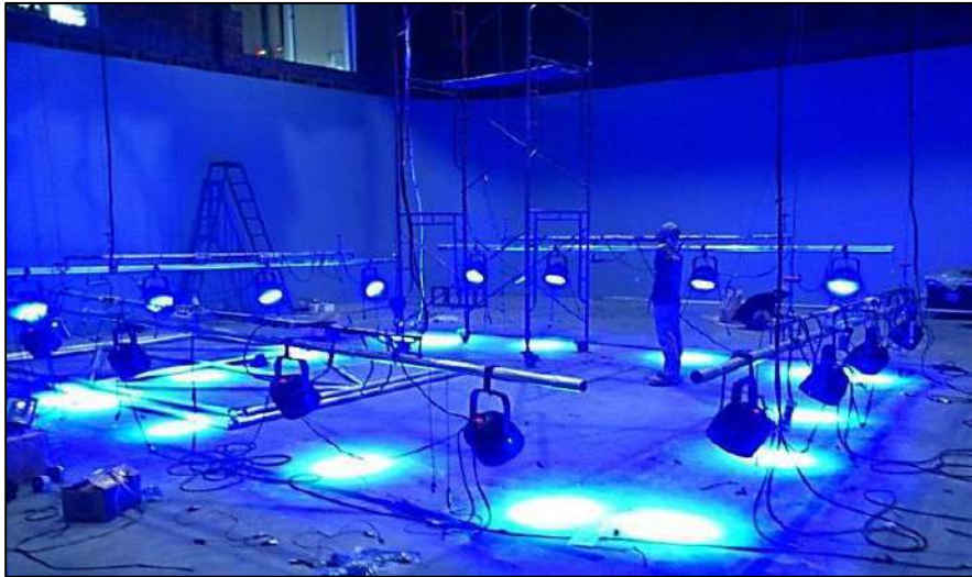
Gambar 255. Pengujian Addressing Lighting PAR LED (Doc Arya. 2015)
