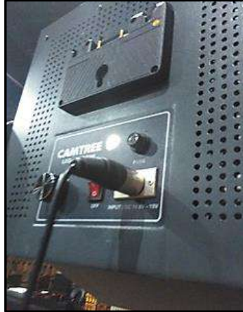
Gambar 112. Penghubungan Kabel Power Lighting (Doc Arya. 2015)
