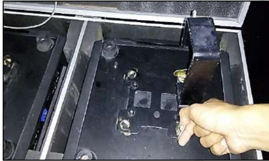
Gambar 231.1. Pengencangan C-clamp Menggunakan Tangan (Doc Arya. 2015)
