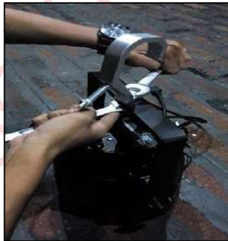
Gambar 218. Pengencangan Baut + Mur
