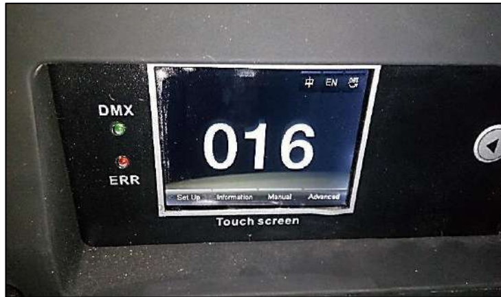
Gambar 253. Moving Head yang Sudah Diberi Adress
