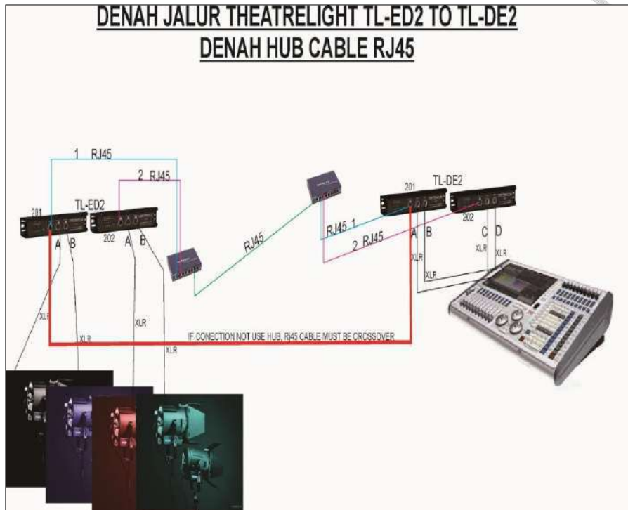
Gambar 298. Rangkaian Lighting Menggunakan HUB
