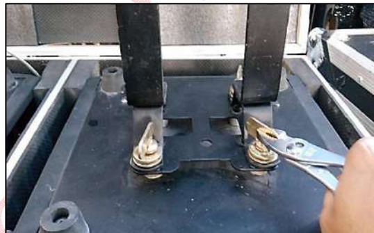
Gambar 232. Pengencangan C-clamp Menggunakan Tang (Doc Arya. 2015)
